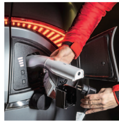
Spannend: Via 230-Volt-Adapter versorgt der EV6 externe Elektrogeräte mit Energie.
