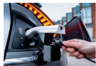
Über den Zusatzadapter: 220-Volt-Steckdose.
